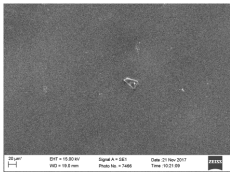
Рис. 4.34. Структура поверхні зразка металокераміки:
