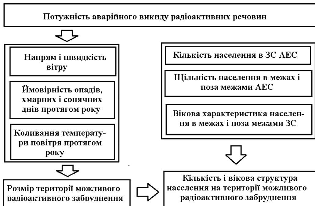
Рис. 3.1. Алгоритм визначення розміру території можливого радіоактивного забруднення та кількості і вікової структури населення на території можливого радіоактивного забруднення
