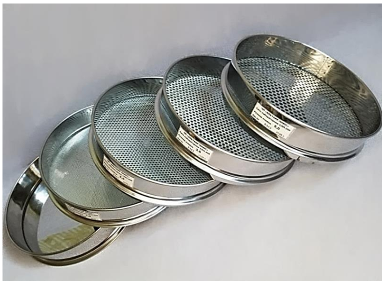
Рисунок 2.11. Набір чотирьох метало-пробивних лабораторних сит СПЛ-200 ПП «Альтаір Плюс» та фрагменти подрібнених зразків тестового матеріалу, розділені за допомогою сит
