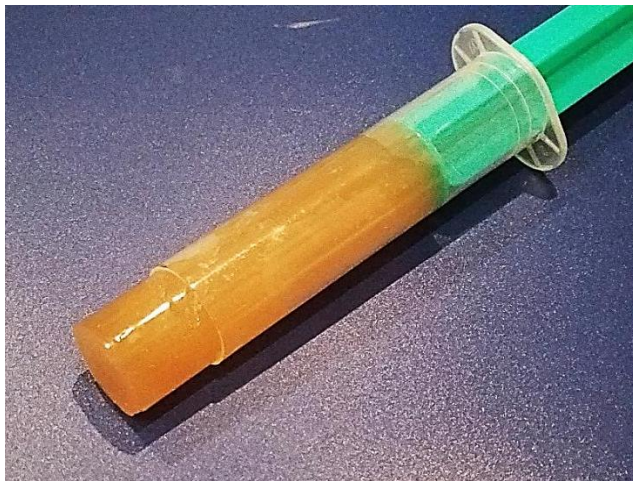
Рисунок 2.10. Зразки тестового матеріалу – агар-агару, виготовлені за методикою УМСА
