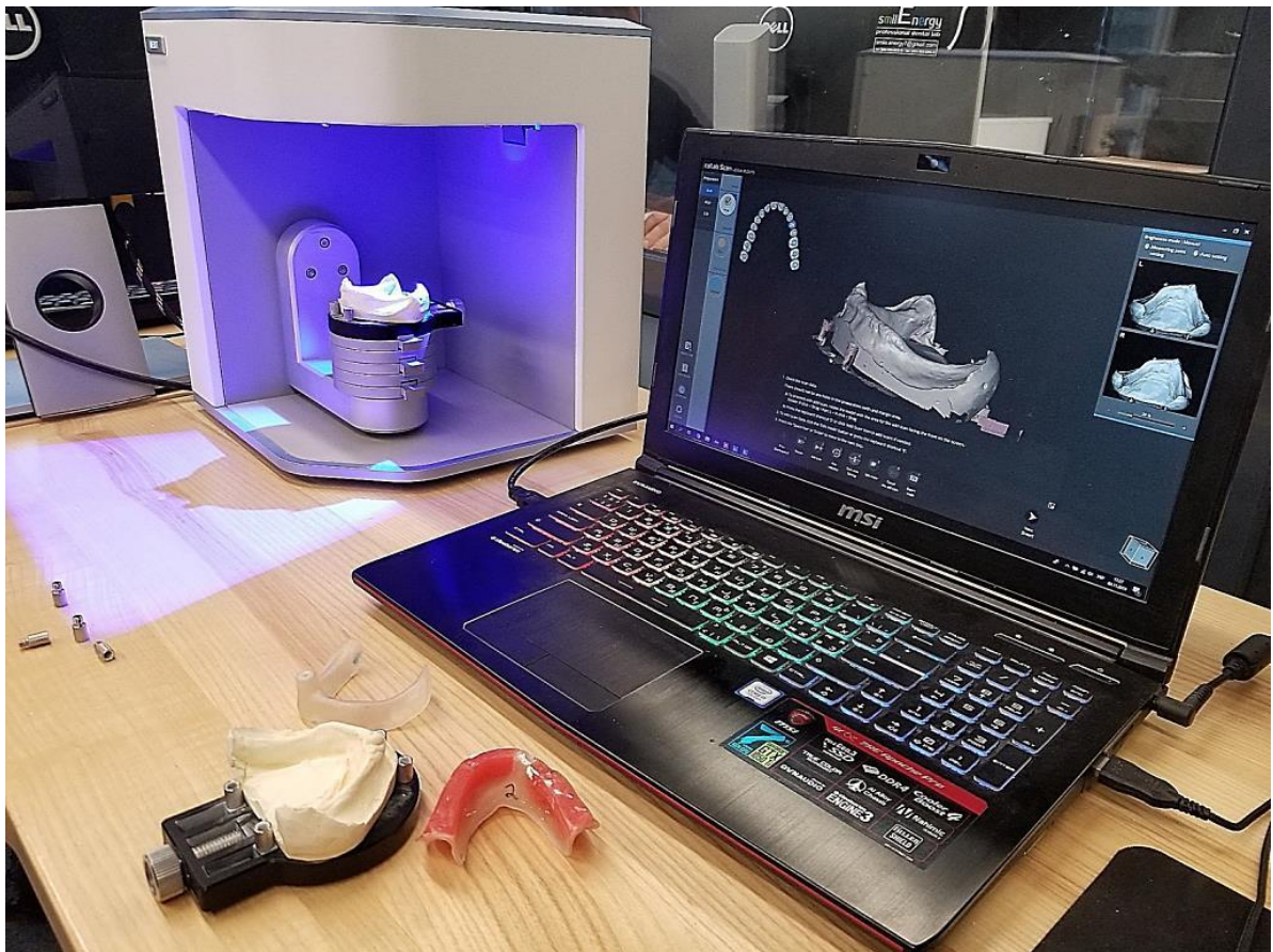
Рисунок 2.7. 3D-сканер Medit Identica T300 у процесі сканування мастер (робочих) моделей та їх зображення у стоматологічному програмному забезпеченні для тривимірного моделювання DentalCAD 2.3 Matera, Exocad
